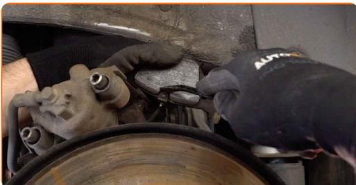
**22** Nainštalujte brzdový strmeň a upevnite ho. Použite imbusový kľúč č. H7. Použite momentový kľúč. Utiahnite ju krútiacim momentom 30 Nm.
