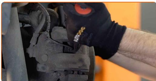
11 Odstráňte krytky prachového puzdra vodiacich závlačiek brzdového strmeňa. Použite páčidlo.
