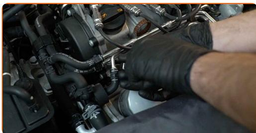
**10** Zaskrutkujte nové sviečky zapalovania a upevnite ich. Použite kľúč na sviečky zapalovania č. 16. Použite momentový kľúč. Uťahnite ju krútiacim momentom 25 Nm.
