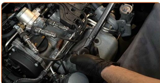
Výmena: zapalovacích sviečok – AUDI A1 Hatchback (8X1, 8XK). Odporúčajú odborníci z AUTODOC:
