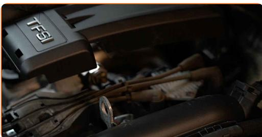
**4** Odstráňte konektory vodičov sviečky zapalovania z otvorov pre sviečky zapalovania. Použite okrúhle kliešte.
