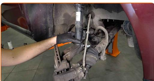
Výmena: horného uloženia tlmiča – AUDI A1 Hatchback (8X1, 8XK). AUTODOC odporúča:
