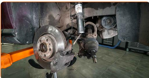
Výmena: horného uloženia tlmiča – AUDI A1 Hatchback (8X1, 8XK). Tip:
