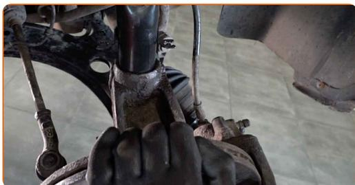
Výmena: horného uloženia tlmiča – AUDI A1 Hatchback (8X1, 8XK). Tip od AUTODOC:
