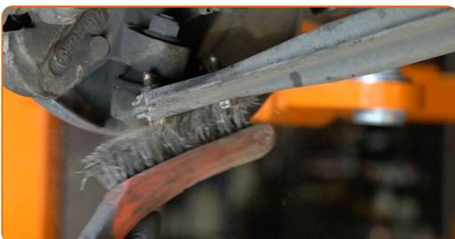
7 Odskrutkujte upevnenie guľového čapu a tiahla riadenia. Použite kombinačný kľúč č. 18.
