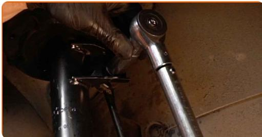
**64** Utiahnite upevnenie guľového čapu. Použite nástavec č.16. Použite momentový klíč. Utiahnite ju krútiacim momentom 60 Nm.
