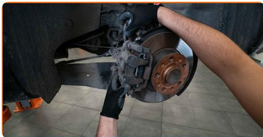
**19** Upevnite svorku brzdového strmeňa. Použite XZN č. 14. Použite momentový kľúč. Utiahnite ju krútiacim momentom 90 Nm.
