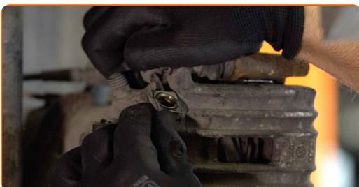
**14** Odpojte spätnú pružinu parkovacej brzdy. Použite kliešte na vodnú pumpu.
