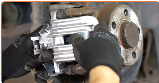
**26** Zaskrutkujte upevňovacie prvky brzdového strmeňa.
