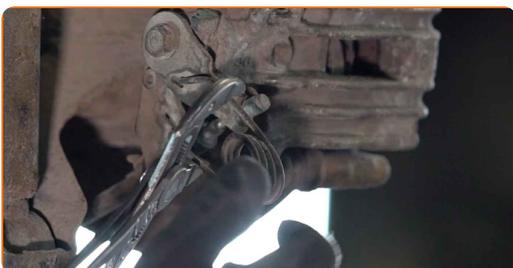
**15** Odstráňte zádržný držiak lanka parkovacej brzdy. Použite páčidlo.
