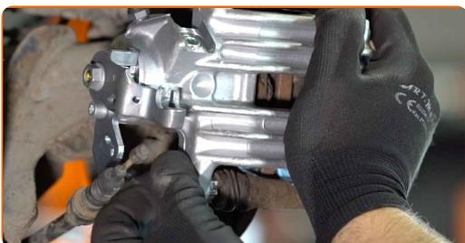
**28** Nainštalujte lanko parkovacej brzdy na držiak brzdového strmeňa. Zaistite lanko parkovacej brzdy pomocou zádržného krúžku.
