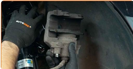
Výmena: brzdových platničiek – AUDI A3 Hatchback (8P1). AUTODOC odporúča:
