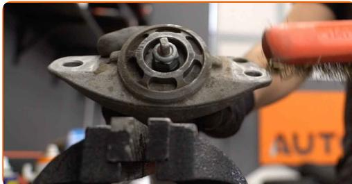
**14** Vyčistite upevňovací prvok tyčky tlmiča. Použite drôtenú kefu. Použite sprej WD-40.
