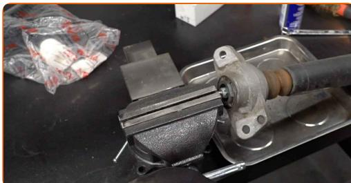
**15** Odstráňte upevnenie tyče piestu tlmiča. Použite kombinačný kľúč č.14.
