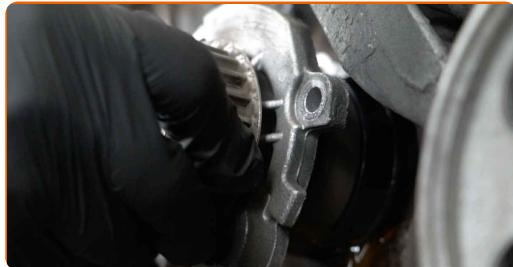
Výmena: vodné čerpadlo & sada ozubeného remeňa – AUDI A3 Sportback (8PA). Odporúčajú odborníci z AUTODOC:
