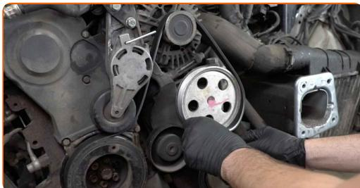
**Výmena: vodné čerpadlo & sada ozubeného remeňa – AUDI A3 Sportback (8PA). Tip:**
