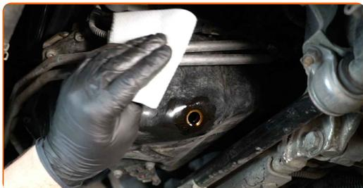
**19** Zaskrutkujte novú zátku výpustného otvoru a utiahnite ju. Použite hviezdicový Torx T45. Použite momentový kľúč. Uťahnite ju krútiacim momentom 26 Nm.
