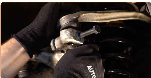
**67** Zaskrutkujte upevňovacie prvky (2 kusy) vrchného ovládacieho ramena. Použite kombinačný kľúč č.18. Použite nástavec č.18.
