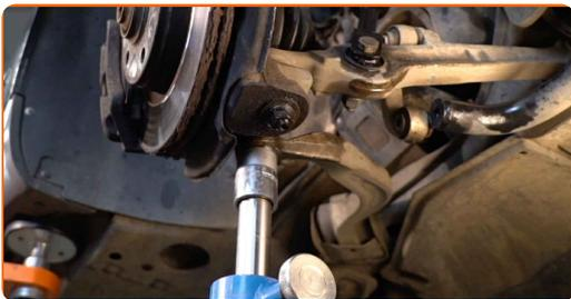
**64** Natrite a ošetríte všetky spojenia ramena. Použite viacúčelové mazivo. Použite plochý skrutkovač.
