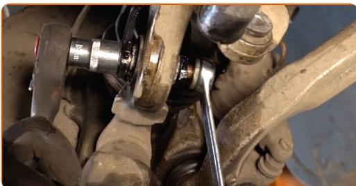
**63** Podprite rameno. Použite zdvihák s hydraulickými prevodmi.
