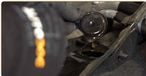
**6** Uvoľnite vrchný upevňovací prvok ložiska vzpery tlmiča. Použite nástavec č.16. Použite ráčňový kľúč.
