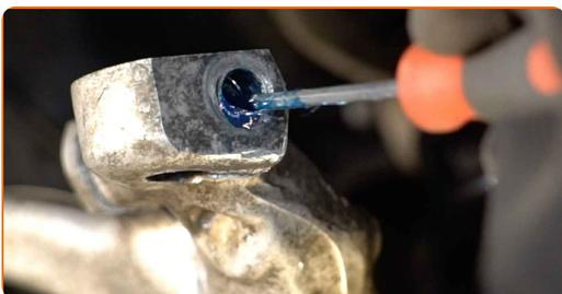
**65** Pripojte vrchné rameno zavesenia kolies k hlave ložiska čapu riadenia (2 kusy).
