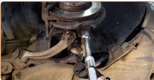
**71** Utiahnite upevňovacie prvky horného priečného ramena (2 kusy). Použite kombinačný kľúč č.18. Použite nástavec č.18. Použite momentový kľúč. Utiahnite ju krútiacim momentom 45 Nm.
