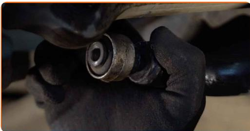
**69** Utiahnite upevňovací prvok vzpery stabilizátora.
