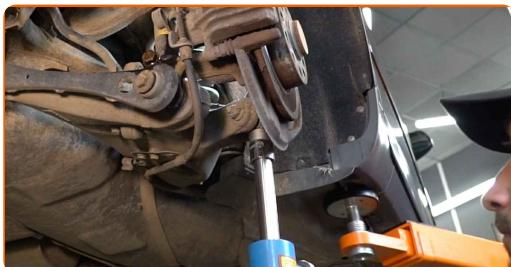
8 Odskrutkujte spodné upevnenie tlmiča. Použite kombinačný kľúč č.21. Použite nástavec č.21. Použite ráčňový kľúč.
