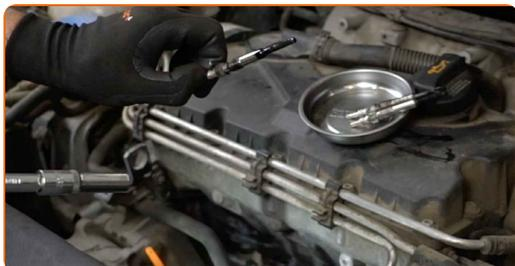
**9** Natrite žeraviace sviečky. Použite vysokoteplotné keramické mazivo.
