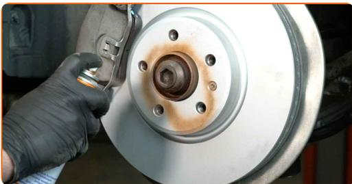
**18** Vyčistite povrch brzdového kotúča. Použite čistič brzd.
