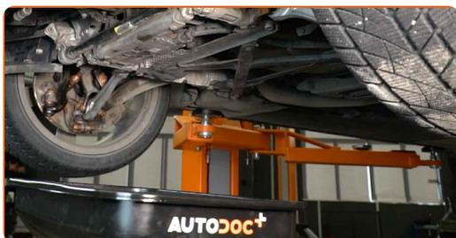
**7** Vyčistite miesto výpustného otvoru olejovej vane. Použite drôtenú kefu. Použite viacúčelový čistiaci sprej.
