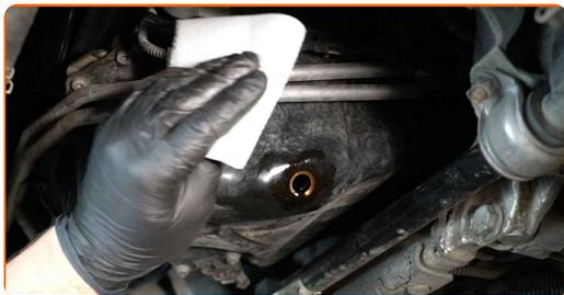
**19** Zaskrutkujte novú zátku výpustného otvoru a utiahnite ju. Použite hviezdicový Torx T45. Použite momentový kľúč. Utiahnite ju krútiacim momentom 26 Nm.
