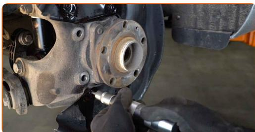
**18** Odstráňte kryt brzdového kotúča.
