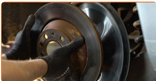
**16** Vyčistite upevňovacie prvky krytu brzdového kotúča. Použite drôtenú kefu. Použite sprej WD-40.
