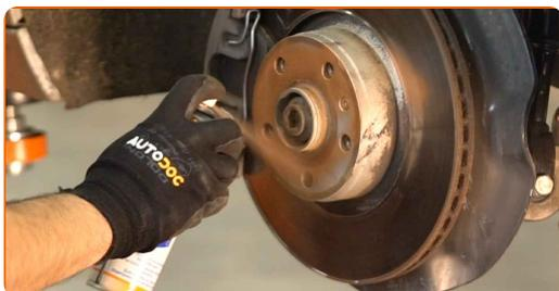
**19** Vyčistite povrch brzdového kotúča. Použite čistič brzd.
