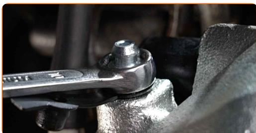
**37** Vypustite systém brzdového strmeňa. Bez naštartovania motora stlačte brzdový pedál niekoľkokrát, až kým nebudete cítiť značný odpor.
