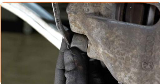
**15** Odskrutkujte upevnenie brzdového strmeňa. Použite imbusový kľúč č. H7. Použite ráčňový kľúč.
