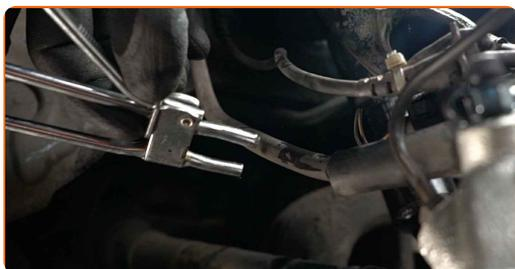
**35** Zapojte set na odvzdušnenie brzd do skrutky prvku na odvzdušnenie brzd.
