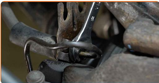
**14** Odstráňte krytky prachového puzdra vodiacich závlačiek brzdového strmeňa. Použite páčidlo.
