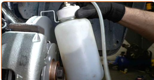
**36** Odpojte skrutku prvku na odvzdušnenie brzd. Použite kombinačný kľúč č.10.
