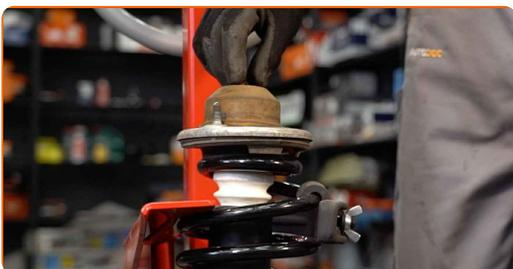
**43** Upevnite maticu piestu vzpery tlmiča. Použite imbusový kľúč č. H6. Použite nástavec č.18. Použite momentový kľúč. Utiahnite ju krútiacim momentom 50 Nm.
