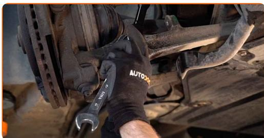
**55** Vyčistite montážne otvory a závit ramena odpruženia. Použite drôtenú kefu. Použite sprej WD-40.
