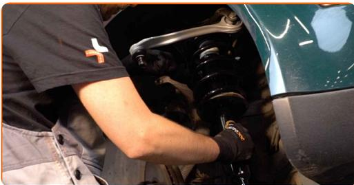
**50** Zaskrutkujte vrchné upevnenie uloženia vzpery tlmiča. Použite nástavec č.15. Použite ráčňový kľúč. Neuťahujte ho.
