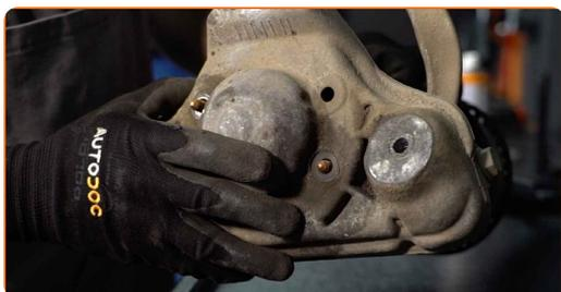
48 Utiahnite vrchné upevnenie uloženia vzpery tlmiča. Použite nástavec č.13. Použite momentový kľúč. Utiahnite ju krútiacim momentom 22 Nm.
