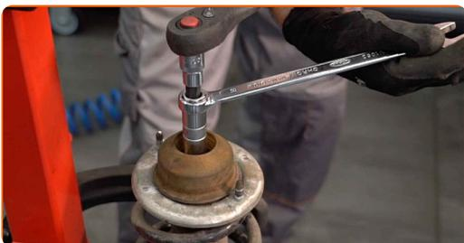
**33** Odstráňte vrchné uloženie vzpery. Použite páčidlo.
