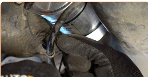
**12** Nádobu na kvapalinu odstráňte spod palivového filtra.
