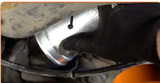
**11** Pripevnite upevňovacie prvky palivového filtra. Použite strihacie kliešte.
