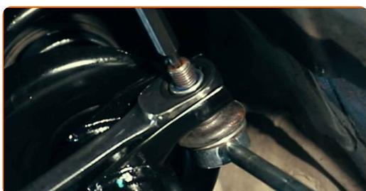
**12** Utiahnite upevnenie spájajúce vzperu stabilizátora k vzpere tlmiča. Použite nástavec č.19. Použite momentový kľúč. Utiahnite ju krútiacim momentom 65 Nm.
