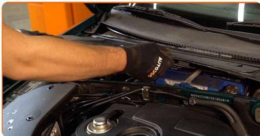
5 Vyčistite upevňovacie prvky vrchného ložiska vzpery tmiča. Použite drôtenú kefu. Použite sprej WD-40.
