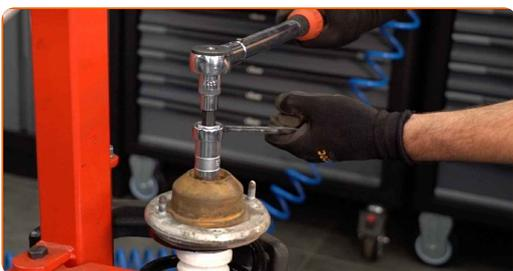
Výmena: jednotka pruženia, tlmič pruženia – VW Passat B5 Variant. AUTODOC odporúča:
