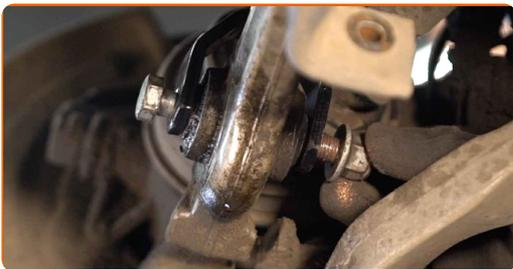
**54** Zaskrutkujte spodný upevňovací prvok tmiča pruženia. Použite kombinačný kľúč č.18. Použite nástavec č.18.
