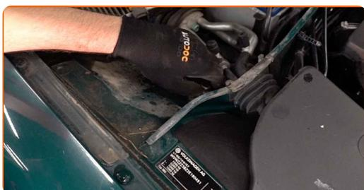
Výmena: jednotka pruženia, tlmič pruženia – VW Passat B5 Variant. Tip od AUTODOC:
