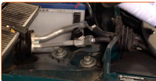
6 Uvoľnite vrchný upevňovací prvok ložiska vzpery tmiča. Použite nástavec č.16. Použite ráčňový kľúč.
