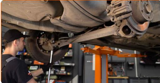
**12** Odskrutkujte spodné upevnenie tlmiča. Použite kombinačný kľúč č.16. Použite nástavec č.16. Použite ráčňový kľúč.
