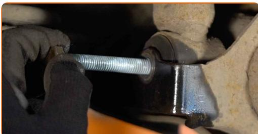
10 Odstráňte upevnenie spod nosníka zadnej nápravy.
