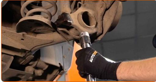
8 Odskrutkujte spodné upevnenie tlmiča. Použite kombinačný kľúč č.16. Použite nástavec č.16. Použite ráčňový kľúč.
