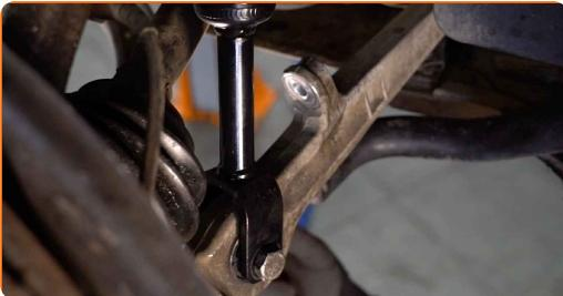
Výmena: tyčky stabilizátora – Audi A4 B6 Avant. Tip od AUTODOC:
