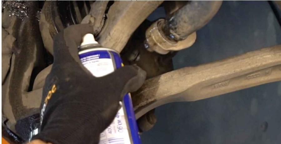
17 Odskrutkujte upevňovacie prvky spájajúce vzperu stabilizátora a stabilizátor. Použíte kombináčny kľúč č. 16. Použíte nástavec č. 16. Použíte ráčnový kľúč.
