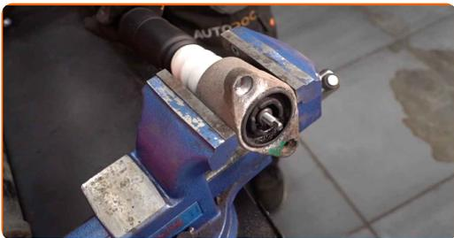
**21** Zaskrutkujte vrchné uloženie piestu vzpery tlmiča. Použite rozperný nástavec na demontáž tlmičov DDN<sup>®</sup>6. Použite nástavec č.16. Použite momentový kľúč. Uťahnite ju krútiacim momentom 25 Nm.
