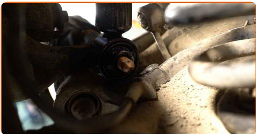
**28** Zaskrutkujte spodné upevnenie tlmiča. Použite kombinačný kľúč č.21. Použite nástavec č.21. Použite ráčňový kľúč.
