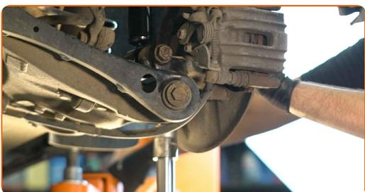
**30** Utiahnite spodné upevnenie tlmiča. Použite kombinačný kľúč č.21. Použite nástavec č.21. Použite momentový kľúč. Utiahnite ju krútiacim momentom 150 Nm.+90°
