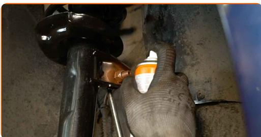
**66** Natrite povrch, kde je brzdový kotúč v kontakte s ráfikom kolesa. Použite medené mazivo.
