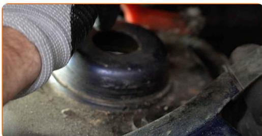
**7** Uvoľnite vrchný upevňovací prvok ložiska vzpery tlmiča. Použite nástavec č.13. Použite ráčňový kľúč.
