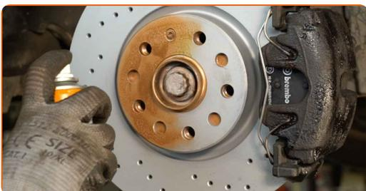
**67** Vyčistíte povrch brzdového kotúča. Použite čistič brzd.
