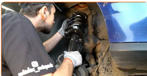
**49** Zaskrutkujte vrchné upevnenie uloženia vzpery tlmiča. Neuťahujte ho.
