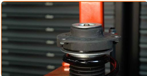
**44** Upevnite maticu piestu vzpery tlmiča. Použite nástavec č.19. Použite imbusový kľúč č. H6. Použite momentový kľúč. Utiahnite ju krútiacim momentom 60 Nm.
