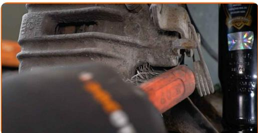
**8** Odskrutkujte upevnenie brzdového strmeňa Použite kombinačný kľúč č.13. Použite kombinačný kľúč č.16.
