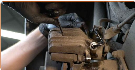
**11** Odstráňte brzdový strmeň. Použite plochý skrutkovač.
