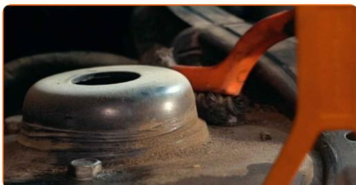
7 Uvoľnite horné upevňovacie prvky tmiča. Použite nástavec č.13. Použite ráčňový kľúč.
