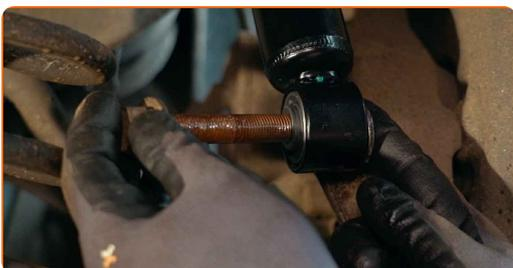
**34** Zaskrutkujte spodné upevnenie tlmiča. Použite nástavec č.21. Použite ráčňový kľúč.
