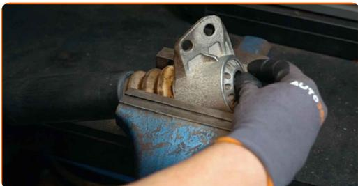
**25** Zaskrutkujte vrchné uloženie piestu vzpery tlmiča Použite nástavec č.17. Použite rozperný nástavec na demontáž tlmičov DD č.5,2. Použite momentový kľúč. Utiahnite ju krútiacim momentom 25 Nm.
