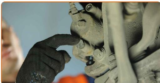
**21** Nainštalujte zádržnú pružinu brzdrového strmeňa. Použite plochý skrutkovač.
