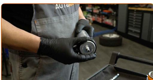
**11** Zaskrutkujte fixačné skrutky na svorku palivového filtra. Použite hviezdicový Torx T40. Použite ráčňový kľúč.
