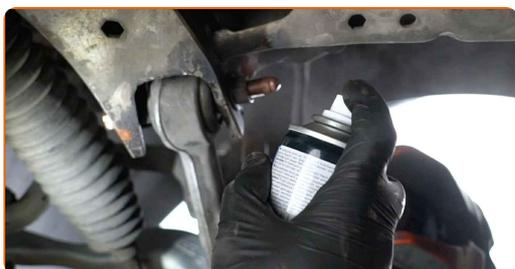
**75** Natrite povrch, kde je brzdový kotúč v kontakte s ráfikom kolesa. Použite medené mazivo.
