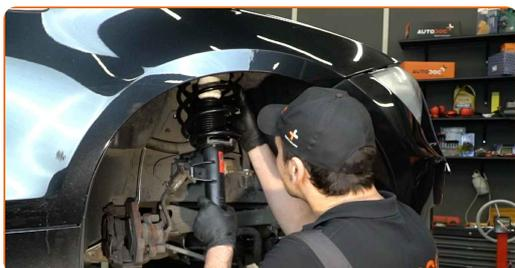
**50** Zaskrutkujte vrchné upevnenie uloženia vzpery tlmiča. Neuťahujte ho.
