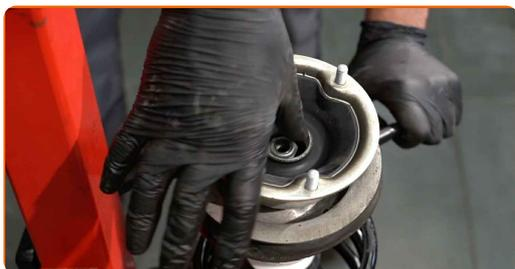
**43** Upevnite maticu piestu vzpery tlmiča. Použite nástavec č.21. Použite imbusový kľúč č. H6. Použite momentový kľúč. Utiahnite ju krútiacim momentom 64 Nm.
