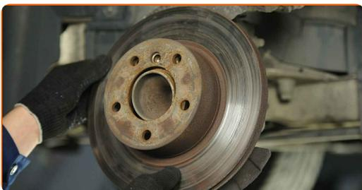
**21** Vyčistite náboj. Použite drôtenú kefu. Natrite kontaktný povrch. Použite medené mazivo.
