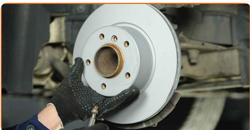
**23** Upevnite upevnenie brzdového kotúča. Použite imbusový kľúč č. H6. Použite momentový kľúč. Utiahnite ju krútiacim momentom 16 Nm.
