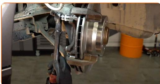
**29** Natrite piest brzdového strmeňa. Použite čistič brzd.
