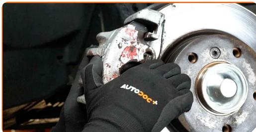
**29** Upevnite svorku brzdového strmeňa. Použite nástavec č.16. Použite momentový kľúč. Utiahnite ju krútiacim momentom 110 Nm.
