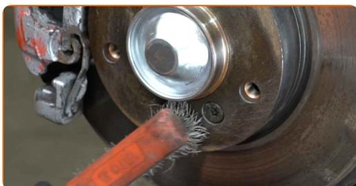
**31** Natrite povrch, kde je brzdový kotúč v kontakte s ráfikom kola. Použite medené mazivo.
