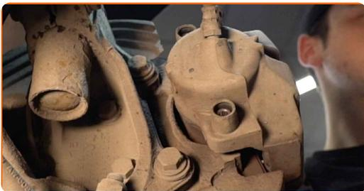
**11** Odskrutkujte upevnenie brzdového strmeňa. Použite imbusový kľúč č. H7. Použite ráčňový kľúč.
