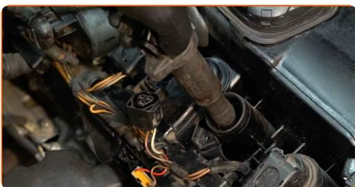
**16** Natrite hroty cievky zapalovania. Použite vysokoteplotné mazivo. Použite plochý skrutkovač.
