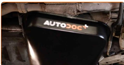
10 Vyčistite miesto výpustného otvoru olejovej vane. Použite drôtenú kefu. Použite viacúčelový čistiaci sprej.
