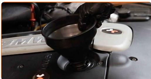
25 Nový olej nalejte do motora, a to v množstve, ktoré odporúča výrobca auta.
