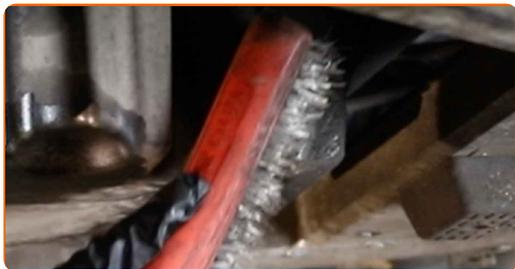
11 Odskrutkujte výpust. Použite nástavec č.19. Použite ráčňový kľúč.
