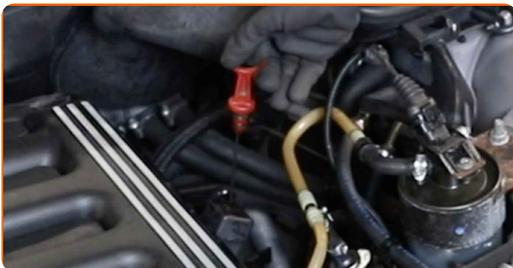
5 Vyčistite uzáver krytu olejového filtra. Použite viacúčelový čistiaci sprej.
