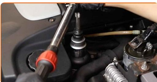
23 Odstráňte uzáver olejového systému.
