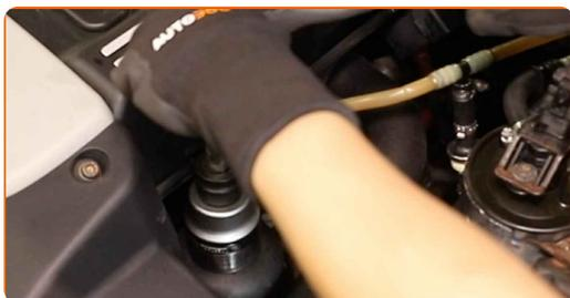
7 Starý olejový filter vložte do nádoby.
