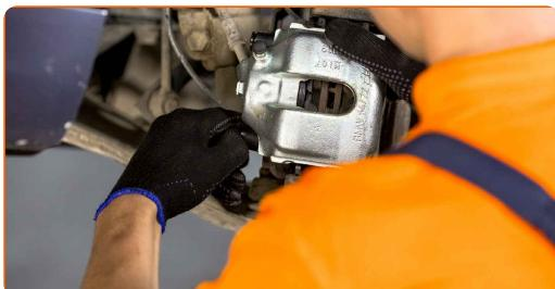
**22** Odpojte skrutku prvku na odvzdušnenie bŕzd. Použite kombinačný kľúč č.9.
