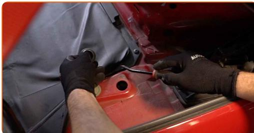
**3** Vyčistite upevňovacie prvky vrchného ložiska tlmiča. Použite sprej WD-40.
