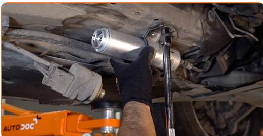
21 Pripevnite regulátor tlaku paliva k palivovému filteru. Nainštalujte zacvakávací krúžok na sponu regulátora tlaku paliva.
