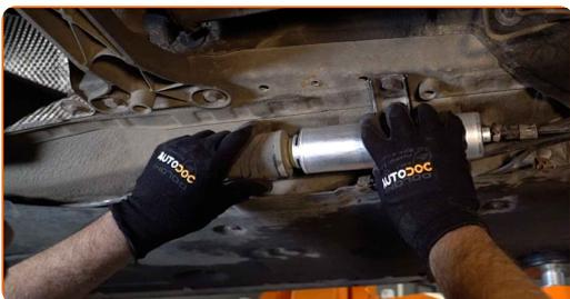
22 Nádobu na kvapalinu odstráňte spod palivového filtra.
