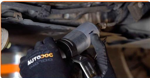
19 Utiahnite upevnenie držiaka palivového filtra. Použite hviezdicový Torx T20. Použite ráčňový kľúč.
