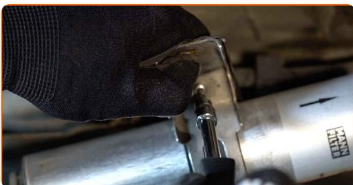
20 Utiahnite upeňovacie prvky palivového filtra. Použite nástavec č.13. Použite ráčňový kľúč.
