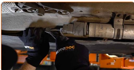
10 Odpojte regulátor tlaku paliva od palivového filtra. Použite páčidlo.
