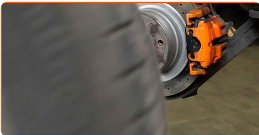
**10** Odpojte snímač opotrebenia brzdových platničiek. Použite páčidlo.
