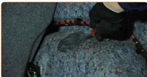
**23** Vyčistite upevňovacie prvky vrchného ložiska tlmiča. Použite drôtenú kefu. Použite sprej WD-40.
