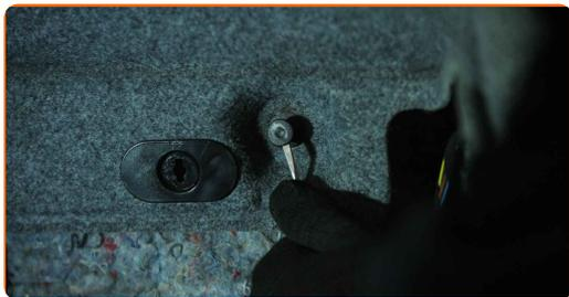
**20** Odskrutkujte upevňovací prvok bočného obloženia kufra. Použite hviezdicový Torx T25. Použite ráčňový kľúč.
