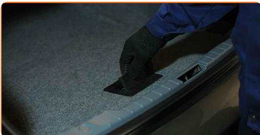
**15** Odstráňte spony z plastového chrániča prahu kufra. Použite ploché skrutkovače (2 kusy).
