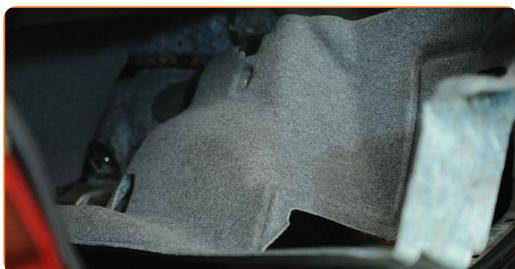
**36** Zaskrutkujte upevňovací prvok bočného obloženia kufra. Použite hviezdicový Torx T25. Použite ráčňový kľúč.
