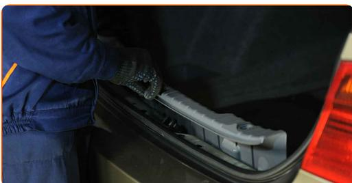
**40** Zaskrutkujte upevňovacie prvky plastového chrániča prahu kufra. Použite krížový skrutkovač PH.
