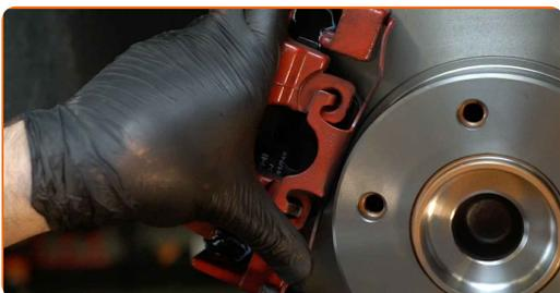
**39** Natrite povrch, kde je brzdový kotúč v kontakte s ráfikom kolesa. Použite medené mazivo.
