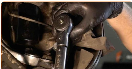
**33** Natrite piest brzdového strmeňa. Použite čistič brzd.
