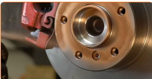
**40** Vyčistite povrch brzdového kotúča. Použite čistič brzd.
