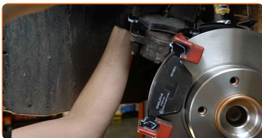
**36** Nainštalujte brzdový strmeň a upevnite ho. Použite imbusový kľúč č. H7. Použite momentový kľúč. Utiahnite ju krútiacim momentom 30 Nm.
