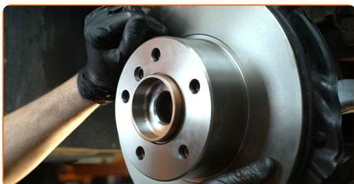
**29** Upevnite upevnenie brzdového kotúča. Použite imbusový kľúč č. H6. Použite momentový kľúč. Utiahnite ju krútiacim momentom 16 Nm.
