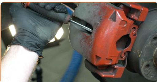
**17** Odpojte zádržnú pružinu brzdového strmeňa. Použite páčidlo.
