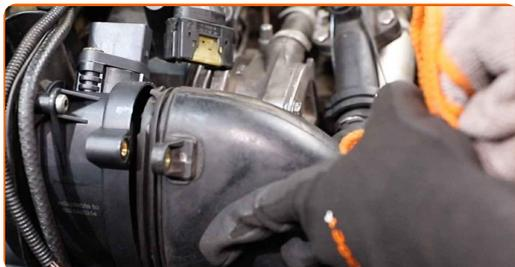
26 Utiahnite upevňovacie prvky, ktoré spájajú vzduchové vedenie k snímaču množstva vzduchu. Použite imbusový kľúč č. H5. Použite momentový kľúč. Utiahnite ju krútiacim momentom 5 Nm.
