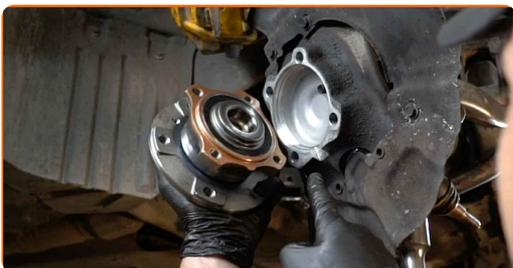
**37** Upevnite náboj. Použite nástavec č.18. Použite momentový kľúč. Utiahnite ju krútiacim momentom 110 Nm.
