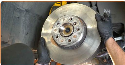
**49** Upevnite upevnenie brzdového kotúča. Použite imbusový kľúč č. H6. Použite momentový kľúč. Utiahnite ju krútiacim momentom 16 Nm.
