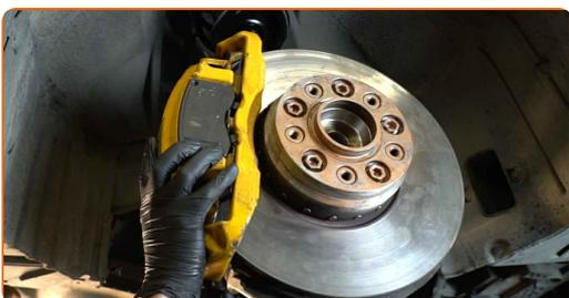
**51** Upevnite svorku brzdového strmeňa. Použite nástavec č.18. Použite momentový kľúč. Utiahnite ju krútiacim momentom 110 Nm.
