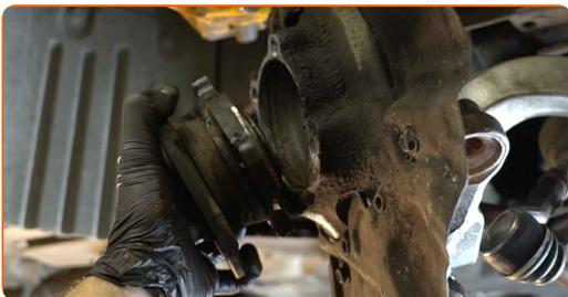
**35** Vyčistite montážny otvor ložiska náboja. Použite drôtenú kefu. Použite viacúčelový čistiaci sprej.
