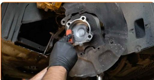
**36** Nainštalujte nový náboj kola s ložiskom.
