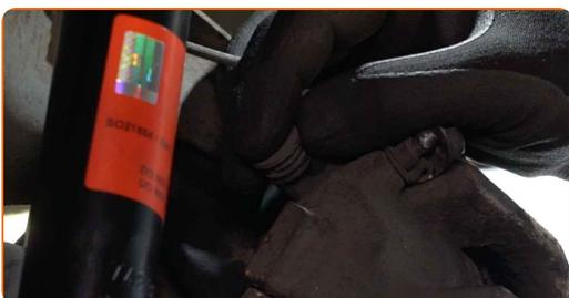
**23** Nainštalujte senzor opotrebenia na brzdové platničky. Použite okrúhle kliešte.
