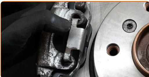
**21** Utiahnite upevňovacie prvky brzdového strmeňa. Použite imbusový kľúč č. H7. Použite momentový kľúč. Utiahnite ju krútiacim momentom 30 Nm.
