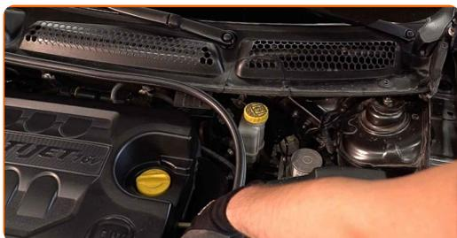
5 Uvoľnite vrchný upevňovací prvok ložiska vzpery tlmiča. Použite kombinačný kľúč č.19
