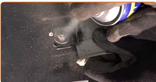
**49** Odskrutkujte upevňovaciú svorku brzdovej hadičky od vzpery tmiča. Použite nástavec č.10. Použite ráčňový kľúč.
