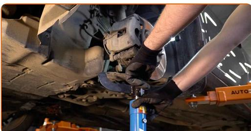
**15** Odskrutkujte spodný upevňovací prvok spájajúci vzperu tlmiča a hlavu ložiska čapu kola. Použite kombinačný kľúč č.15 Použite nástavec č.17. Použite vratidlo.
