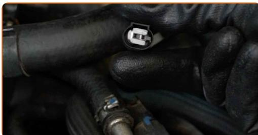
**6** Odpojte podtlakový ventil z jeho montážnej pozície a dajte ho nabok. Použite páčidlo.
